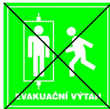
Obrázek B.2 – Piktogram výtahu, který není určen k evakuaci budovy v případě nebezpečí
